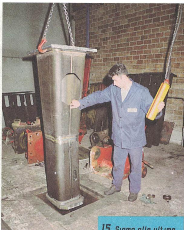
**15** Siamo alle ultime battute del montaggio. La carpenteria per comodità di montaggio viene calata nella "buca". Subito dopo si provvederà all'infilaggio del blocco motore e alla chiusura del tutto mediante la piastra.
