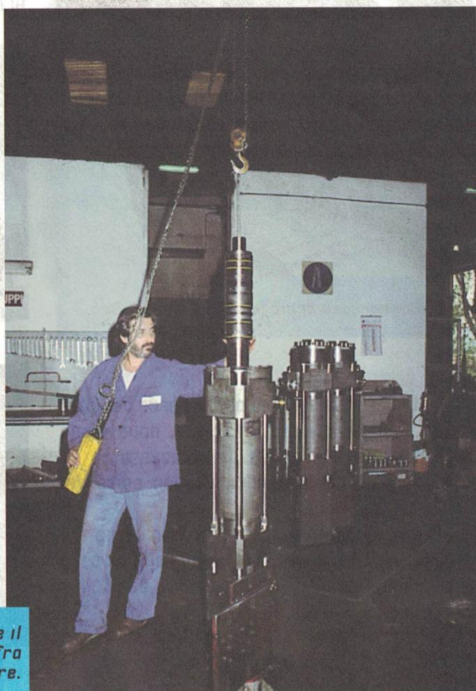
**12** Si infila il pistone nel cilindro. Notare il cilindro già posizionato fra il basamento (in basso) e il distributore.
